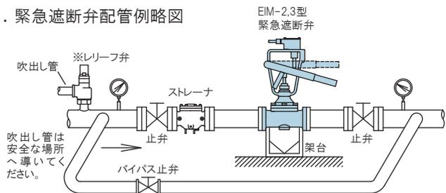
※液体用の場合、ハンマー現象や周囲温度による流体の熱膨張などで昇圧が予想される場合は、レリーフ弁を取り付けてください。
