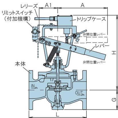
注. 型式、呼び径により構造が多少異なります。レバーの向きは変更することができます。
