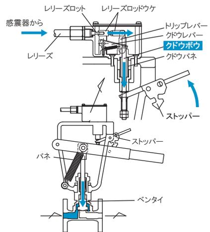
感震器から出力のない平常時は、クドウボウと連結したクドウレバーがトリップレバーによって上側位置で保持されており、クドウボウに連結されたストッパーはロック状態を保持します。(水平状態)
