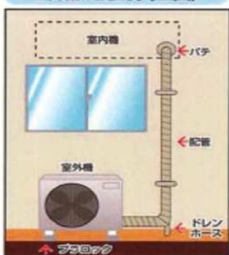
室外機の設置例<正面>
