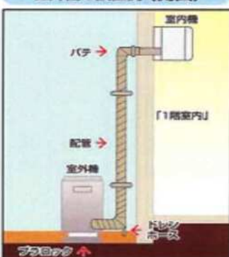
室外機の設置例<側面>
